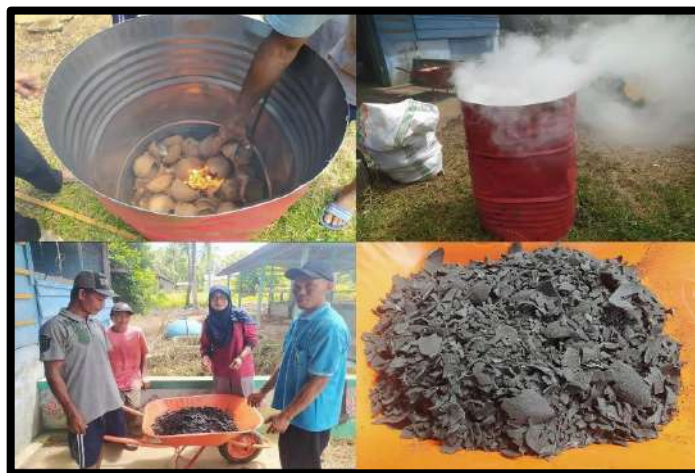
Gambar 3.23. Proses Pembuatan Arang Tempurung Kelapa
