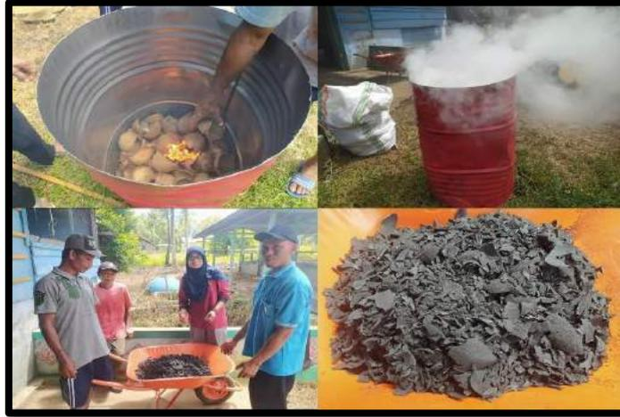
**Gambar 3.23.** Proses Pembuatan Arang Tempurung Kelapa
